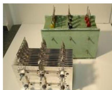
Substitution von Selen-Gleichrichtern in Altanlagen
