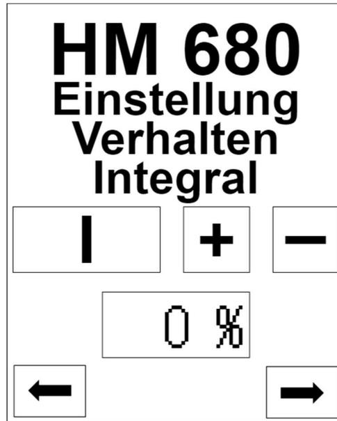
Diese Seite dient zum Anwenden der Integralkonstanten (I)- Einstellung des PID-Reglers durch die Plus- oder Minuszeichen.
