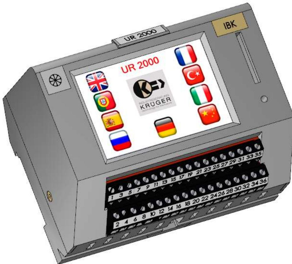
Der von der Industriebberatung Krüger entwickelte Universalregler UR 2000 ist ein programmierbares Modul, welches ähnlich wie eine SPS arbeitet und den Vorteil hat, hochauflösende analoge und digitale Ein- und Ausgänge sowie eine benutzerfreundliche, voll funktionsfähige Mensch-Machine-Schnittstelle mit eingebaut zu haben. Dies ist ein Touchscreen mit neun verschiedenen Sprachen.
